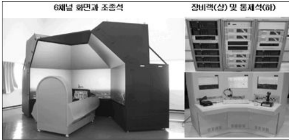
그림 3. 비행모의 훈련 시스템 구성
