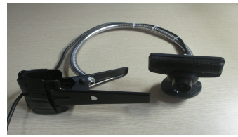
그림 1. 집게형 확대경 예시(좌) 및 완성된 휴대용 웹 카메라 거치대(우)
