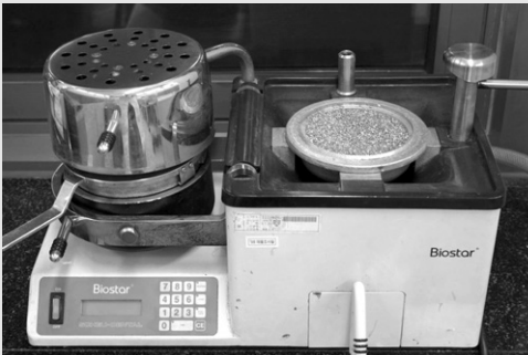
그림 15. pressure moulding 기계에 석고모형을 위치하고 적절한 두께의 레진 sheet를 이용하여 압력을 가한다.
