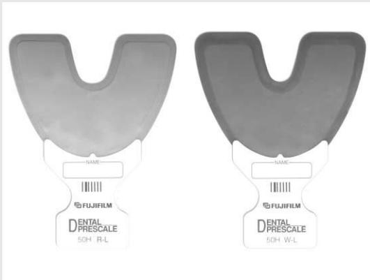
그림 3. Dental Prescale : Prescale (Fuji Film, Tokyo, Japan)
