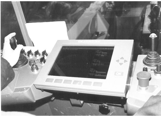
그림 8. Jumbo Drill 내부에 설치된 컴퓨터의 모습
