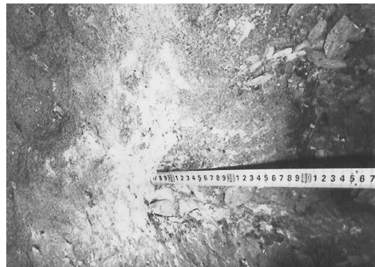
그림 6. COPA-p Cut 발파공법 적용후 측정된 잔류공 깊이의 모습
