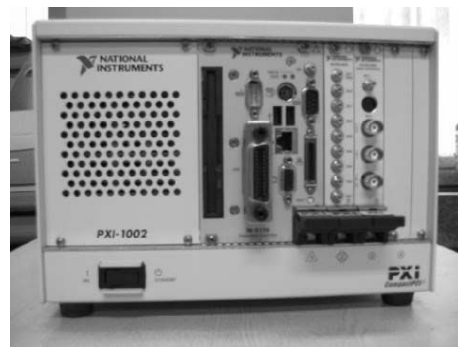
그림 2. 신호 수집장치 (NI4472, National Instrument)
