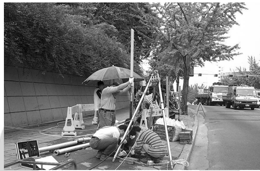
그림 6. 수압파쇄시스템 전경 및 현장시험 광경
