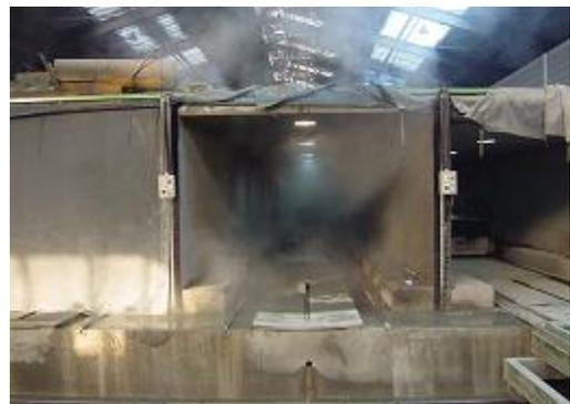
그림 2. 시험체의 증기양생 모습
