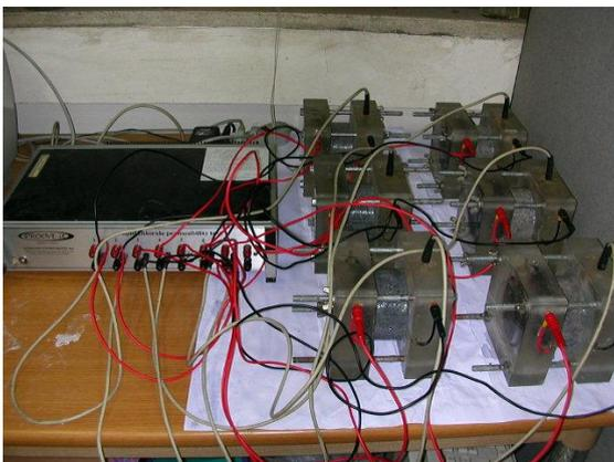
그림 3. 염소이온투과 시험 모습(ASTM C1202)
