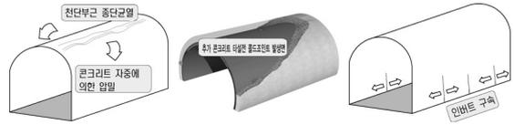
그림 1. 콘크리트 라이닝의 균열 양상
