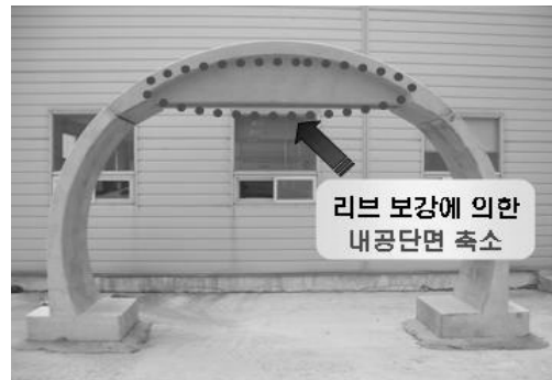
그림 9. 리브 보강에 의한 터널 내공단면 변화
