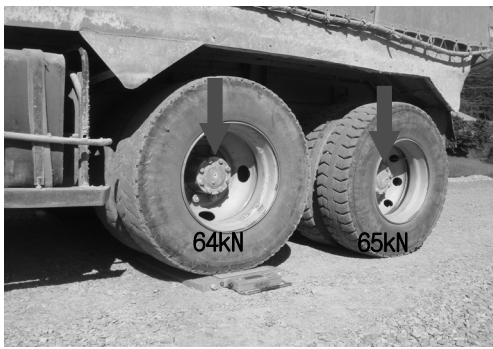
그림 10. 현장실험을 위한 축하중 측정
