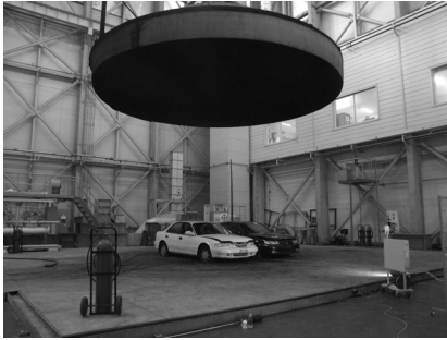
(b) 승용차 실물화재실험 및 열전대 설치(●:열전대)
