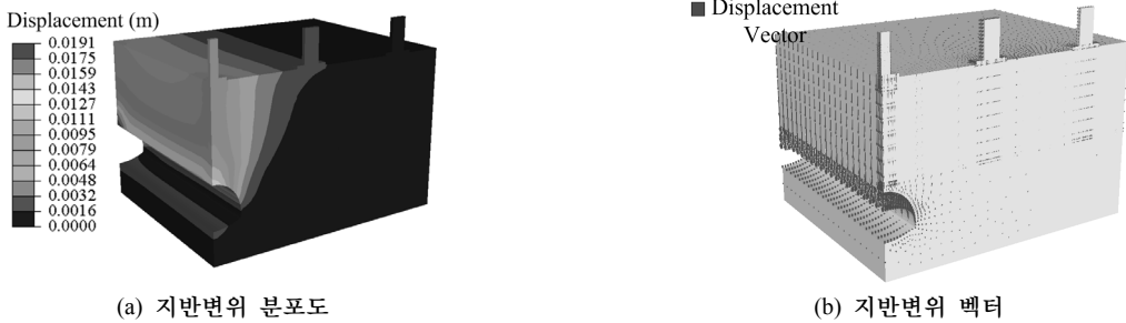
그림 6. 터널 굴착 완료 후 지반변위
