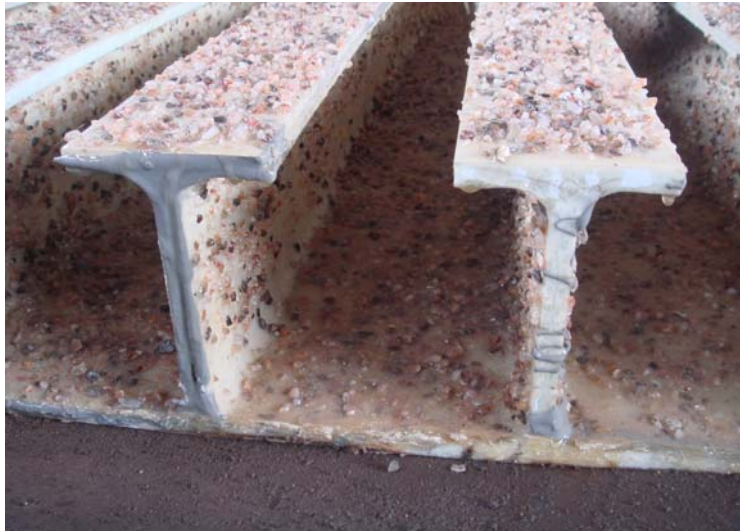
그림 2. FRP 부재 규사코팅 후 전경
