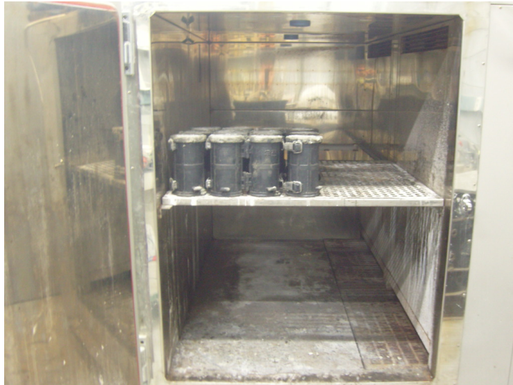
그림 2. 증기양생기에 의한 콘크리트 공시체의 양생
