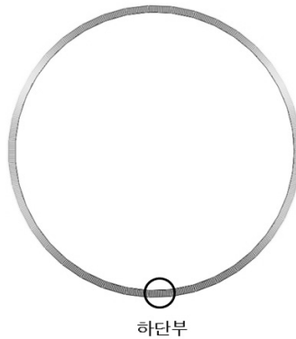
그림 7. x방향 최대축응력 발생 위치
