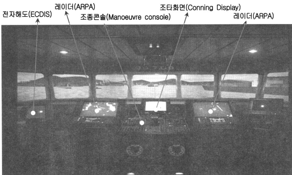
그림 1. 본 연구에서 사용된 선박 시뮬레이터의 선교(bridge) 내부 전경.
